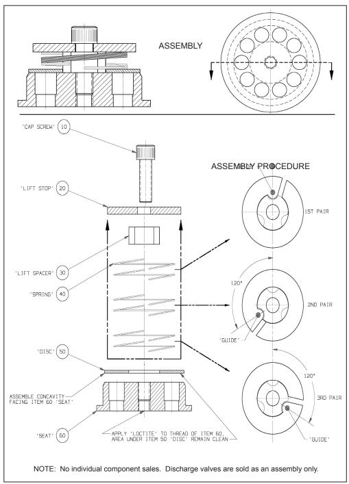
Figure 2. Discharge Valve
